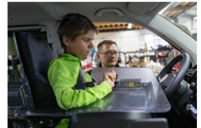
Bevor die Fahrt beginnt, klappt sich der Therapietisch elektrisch vom Elektrorollstuhl nach unten rechts weg. Dank des Drive-by-Wire-Systems „Space Drive“ positioniert sich der 4-Wege-Joystick, mit dem das Fahrzeug gesteuert wird, automatisch in die bevorzugte Position. Zusätzlich gewährleistet eine Rückenstütze den erforderlichen sicheren Halt im Rollstuhl.
